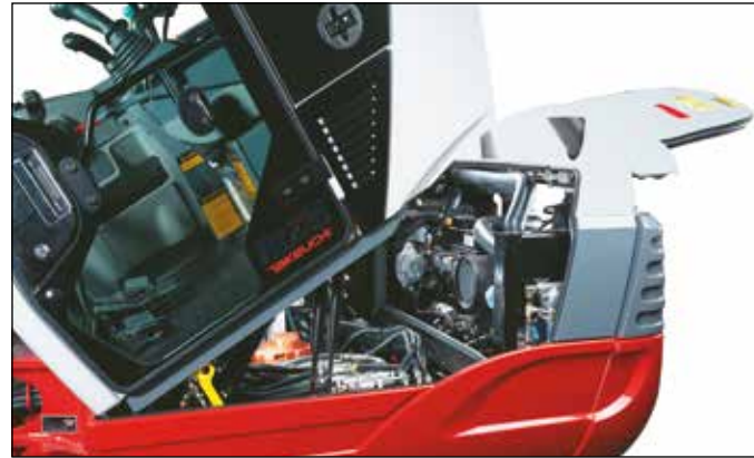
Kippbare Kabine mit servicefreundlichem Zugang zum Motor und den Hydraulikaggregaten.
