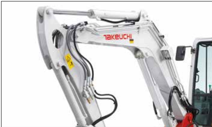
3 Steuerkreise serienmässig, davon 2 proportional gesteuert für eine Vielzahl von Anbaugeräten
