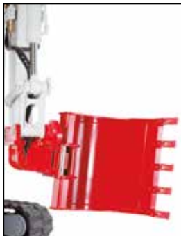
Powertilt mit hydr. Schnellwechselplatte, Tieföffel als Hochöffel montiert
