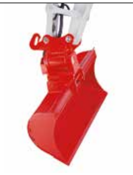
Starrer Grabenräumiöffel mit Powertilt-Schwenkvorrichtung
