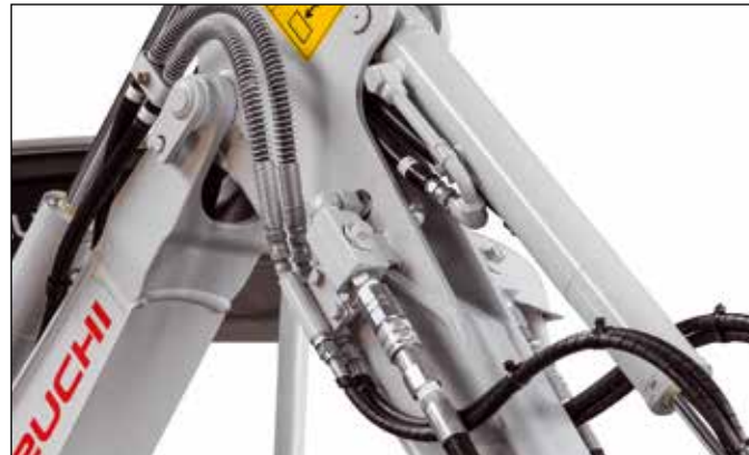
3 circuitos hidráulicos, 1 de ellos dirigido por potenciómetro
