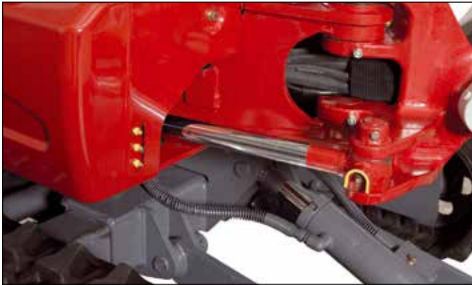
Bloque de giro robusto con cilindro de giro del brazo y latiguillos protegidos
